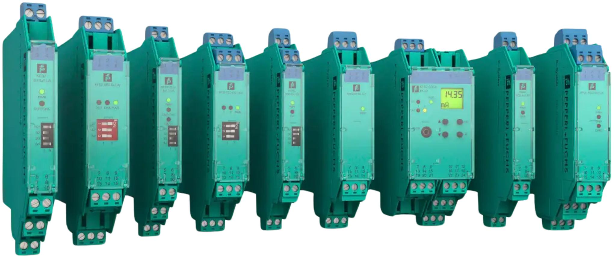
Las **barreras de seguridad intrínseca** de Pepperl+Fuchs limitan la energía que se suministra a un circuito y protegen las zonas peligrosas del exceso de energía. Al limitar la energía a un nivel seguro, evitan la ignición de atmósferas potencialmente explosivas.
